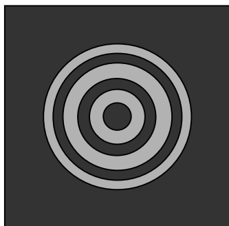
Figure 3. Aspect d'une étoile avec une bonne collimation.
