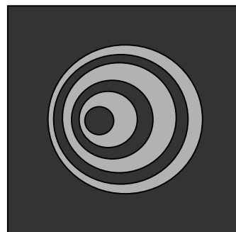
Figure 4. Aspect d'une étoile avec une mauvaise collimation.
